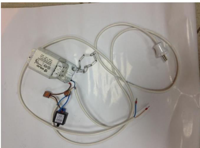
Дроссель(ПРА) крепим цепью с карабином на правую верхнюю балку тента. Оставшиеся 2 провода соединяем с разъемами светильника
