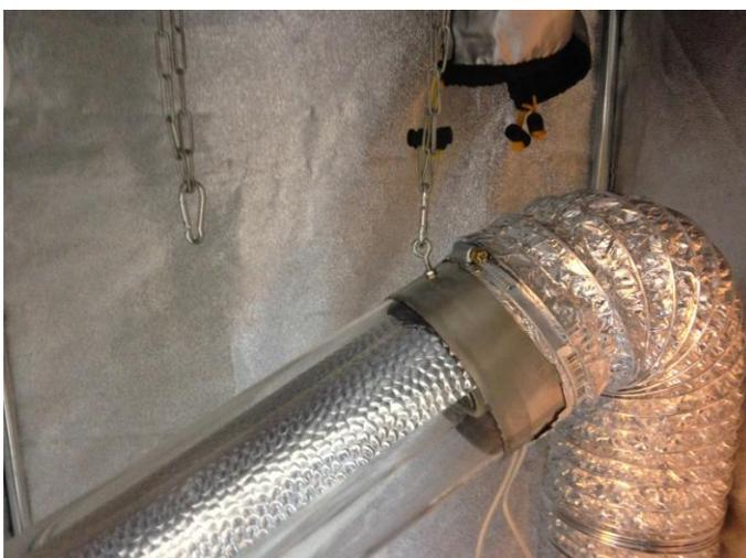
Светильник Cooltube фиксируется к верхней перекладине гроутента цепью и карабинами.
